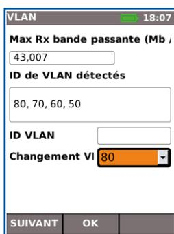
La détection automatique des identifiants VLAN permet à l'utilisateur de configurer NaviTEK NT pour une utilisation sur un VLAN.
